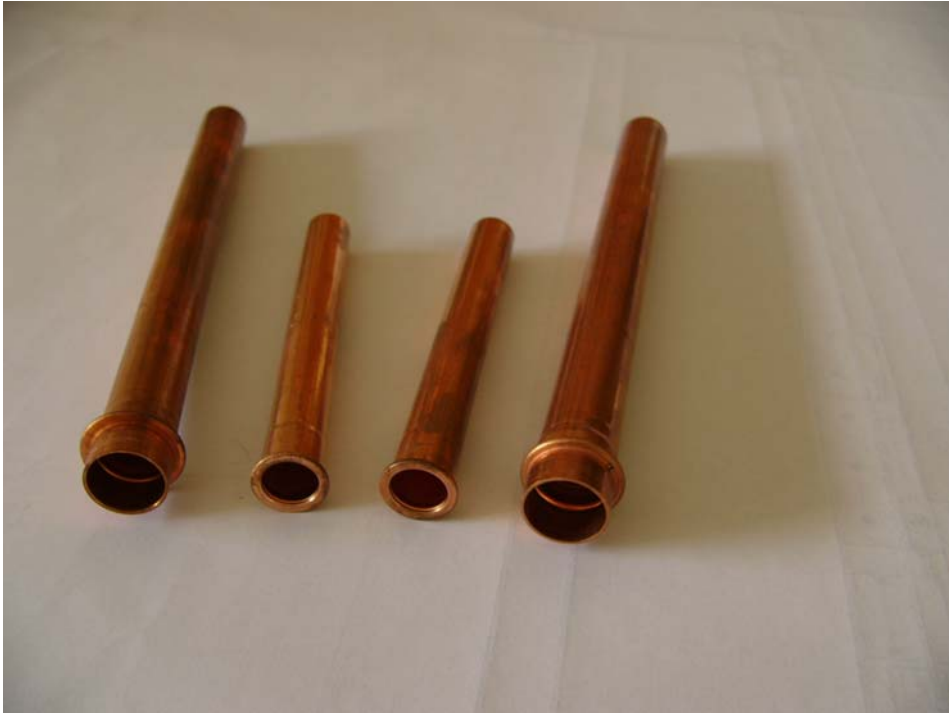
angestauchte Rohr- enden mittels Rohr- endenbearbeitungs- maschine
