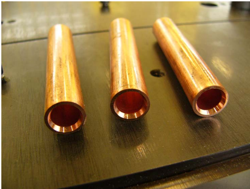
Bearbeitete Rohre mit starker Innen- Fase
