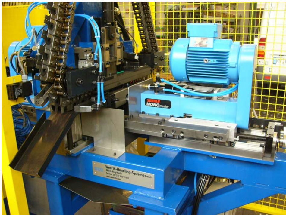
Endbearbeitungs- maschine (spanend) mit Bearbeitung- einheit
