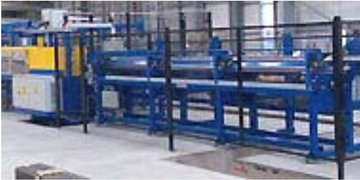
**Spanloses und gratarmes** Trennen von Rohren aus Stahl, rostfreiem Stahl, Al- oder Kupferlegierungen
