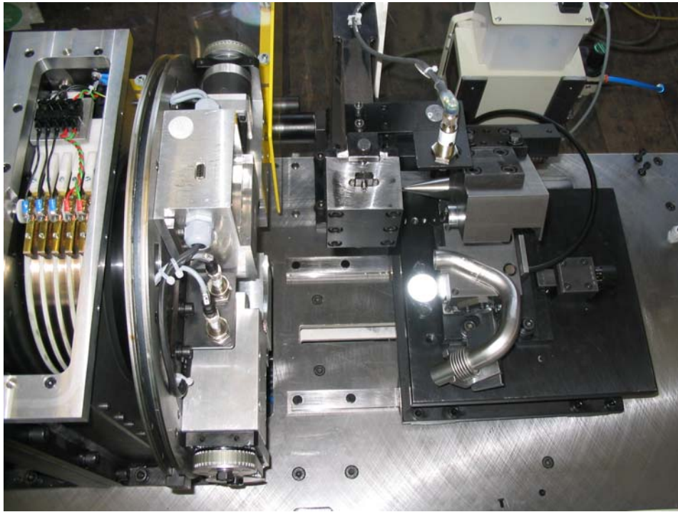
ROTAK mit eingelegtem Rohrbogen im Unterteil der Klemmvorrichtung
