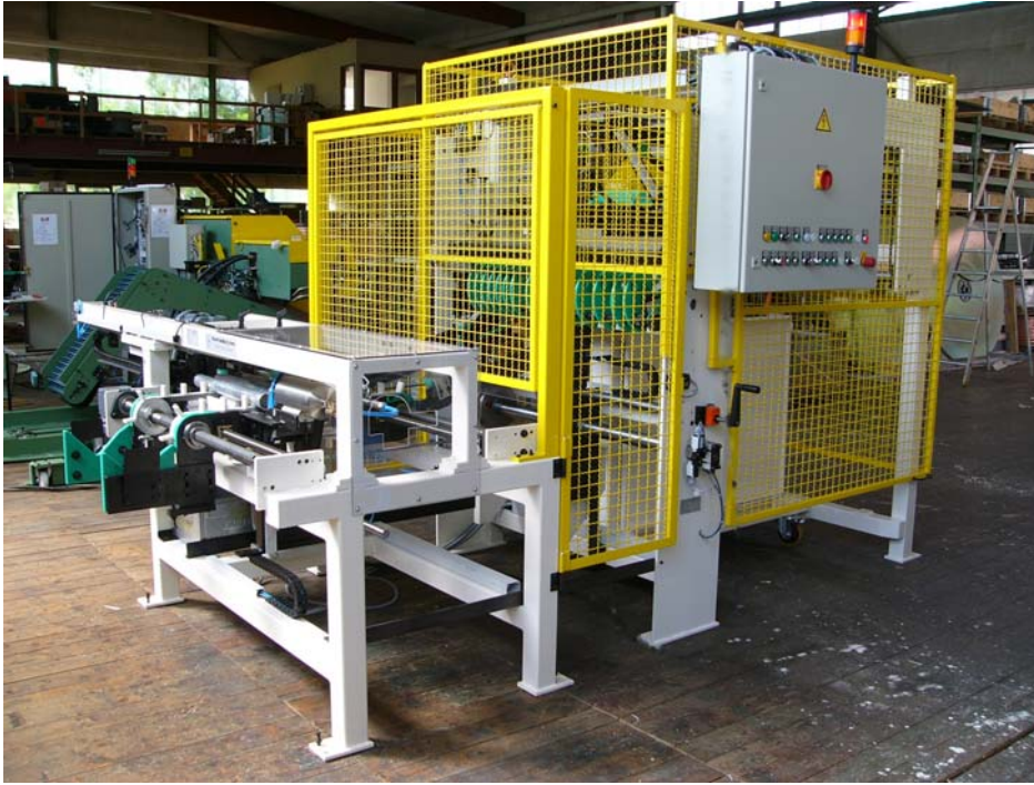
Ausgabereinheit mit Entgratstation und eingestellten Magazinbehälter
